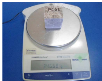
Figura 5. a) Fotografía del peso seco inicial de la probeta PC01
