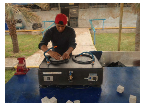
Figura 2. a) Fotografía del lijado de las probetas.
