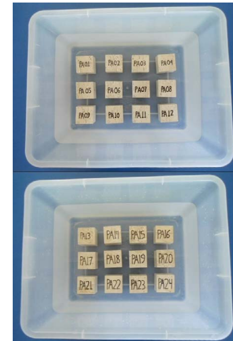
Fig. 9. Fotografía de las 24 probetas inmersas en agua destilada.
