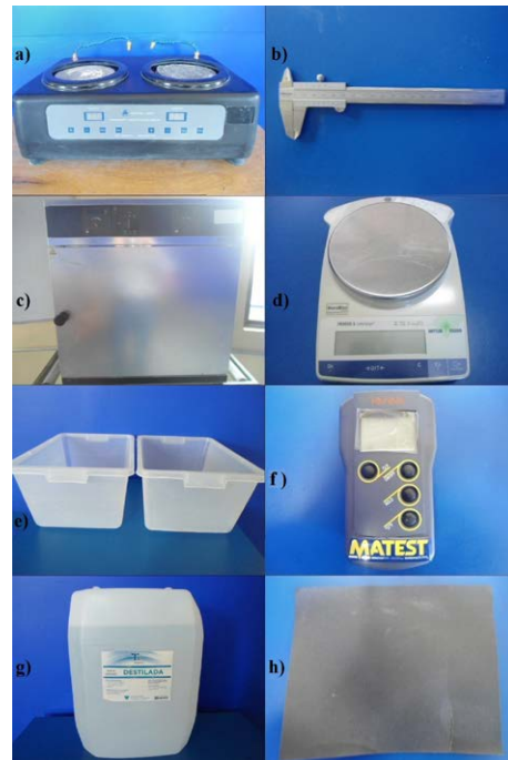
Fig. 4. a) Pulidora marca MTI; b) Vernier analógico marca MITUTOYO; c) Horno de secado marca MEMMERT; d) Báscula digital marca METTLER TOLEDO; e) Contenedor de plástico duro de 16 litros; f) Termómetro digital marca MATEST®; g) Agua destilada marca HERCOTEC; h) Lijas con tamaño de grano 400.
