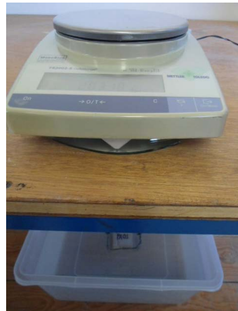
Fig. 11. Fotografía del peso suspendido de la probeta PA01
