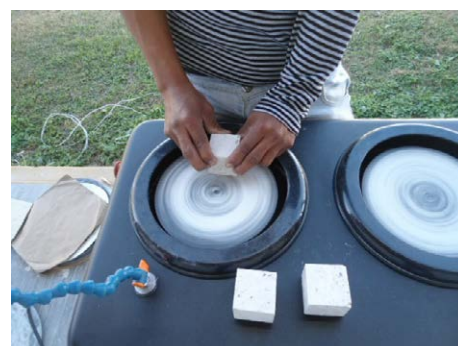
Fig. 5. Fotografía de lijado y pulido de las probetas.
