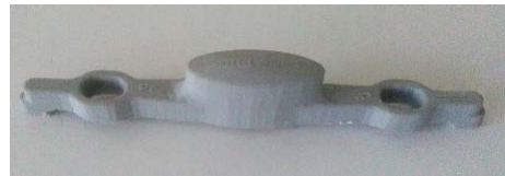
Fig. 10. Impresión 3D del modelo optimizado.
