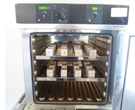
Fig. 7. Fotografía del secado de las 24 probetas.
