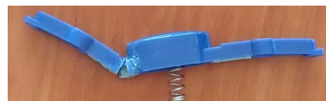
Fig. 2 Mecanismo pulsador fracturado.
