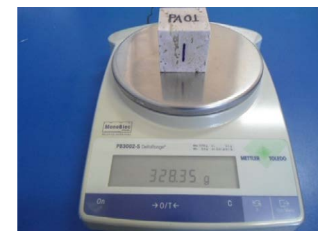
Fig. 10. Fotografía del peso saturado de la probeta PA01
