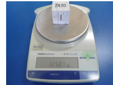
Fig. 8. Fotografía del peso seco de la probeta PA01
