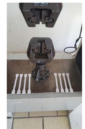
Figura 4.- Máquina universal Shimadzu con probetas.
