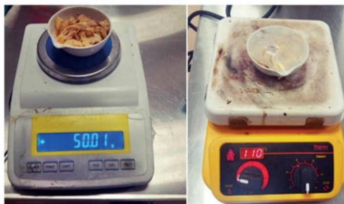
Figura 3. Medición de masa en balanza, ± 0.01 gr y secado en parrilla , ± 1°C.
