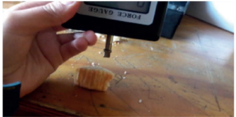
Figura 5. Prueba de corte a panqué con Newtonmetro
