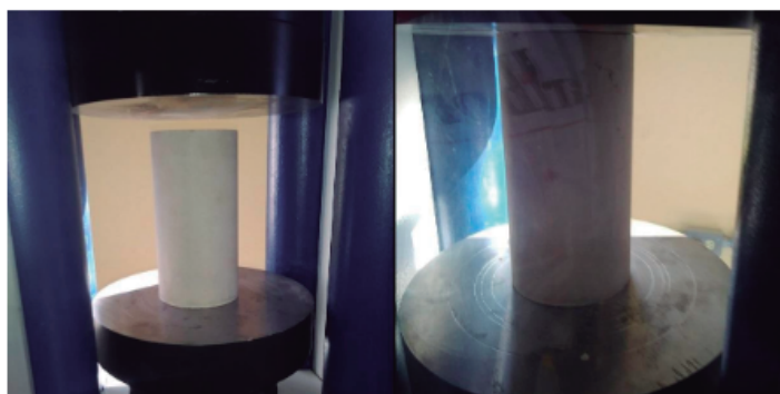
Fig. 10. Fotografías de probetas durante el ensayo de compresión uniaxial.
