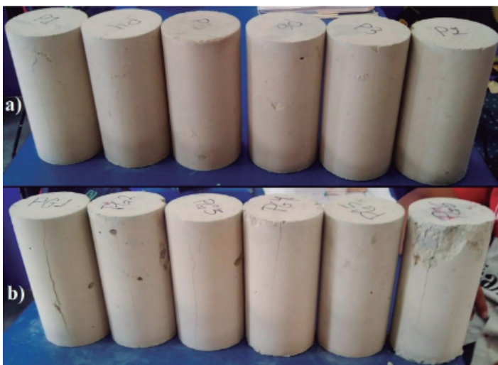
Fig. 11. Fotografías de las probetas después del ensayo de compresión uniaxial: a) Probetas P1-P6; b) Probetas PG1-PG6.
