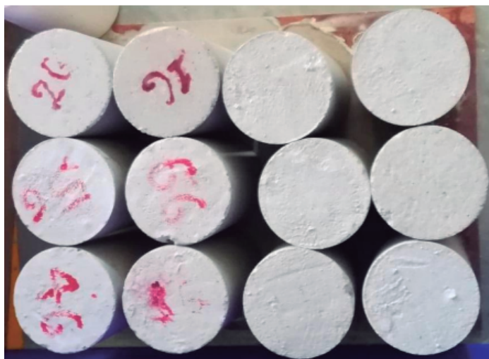
Fig. 7. Fotografía de las probetas fraguadas después de 28 días.
