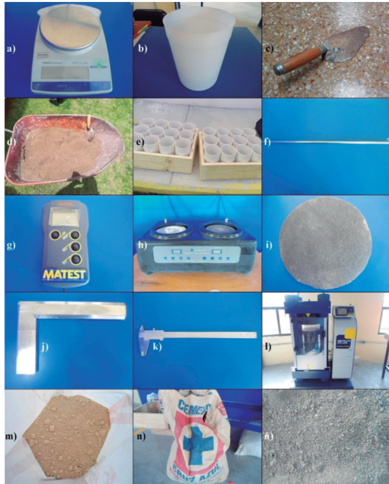
Fig. 3. Fotografías de los equipos y materiales: a) báscula digital marca METTLER TOLEDO modelo SP30002-S; b) Contenedor de plástico; c) Cuchara; d) Carretilla; e) Moldes de plástico; f) Varilla; g) Termómetro digital marca MATEST; h) Pulidora marca MTI modelo UNIPOL-820; i) Lija con tamaño de grano 100; j) Escuadra metálica marca MITUTOYO; k) Vernier marca MITUTOYO modelo 530-115; l) Máquina de compresión marca MATEST; m) Polvo de mármol; n) Cemento marca CRUZ AZUL; ñ) Gravilla.
