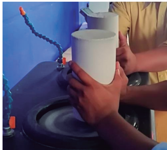
Fig. 8. Fotografía del desbaste de las caras de las probetas.
