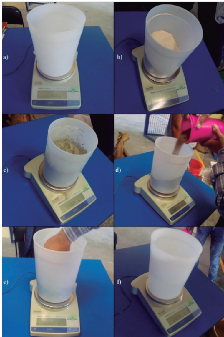
Fig. 4. Fotografías del pesado de los componentes de las mezclas: a) Tara del contenedor; b) Polvo de mármol; c) Cemento; d) Arena; e) Gravilla; f) Agua.
