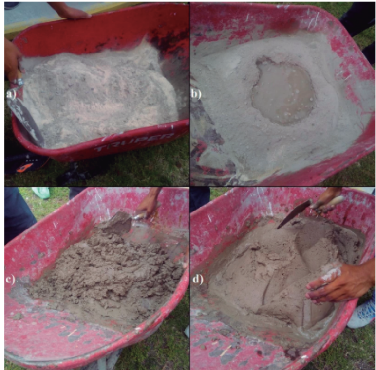
Fig. 5. Fotografías de la obtención de las mezclas: a) Vertido de los compuestos; b) Vertido de agua; c) Mezclado; d) Mezcla finalizada.
