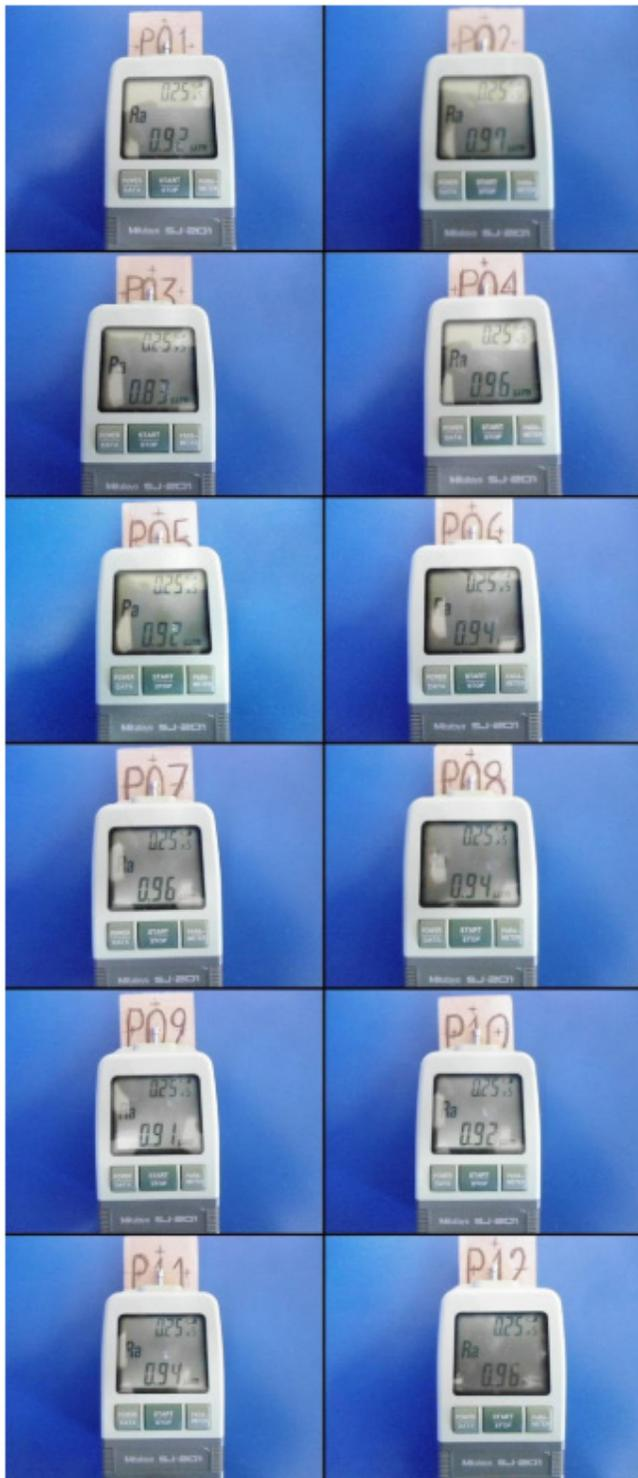
Fig. 7. Fotografía de la rugosidad inicial en el centro de las 12 probetas.
