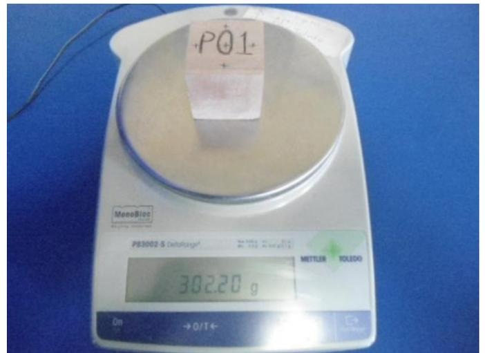
*Fig. 6. Fotografía del peso seco de la probeta P01.*
