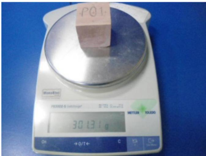
**Fig. 12. Fotografía del peso seco final de la probeta P01.**
