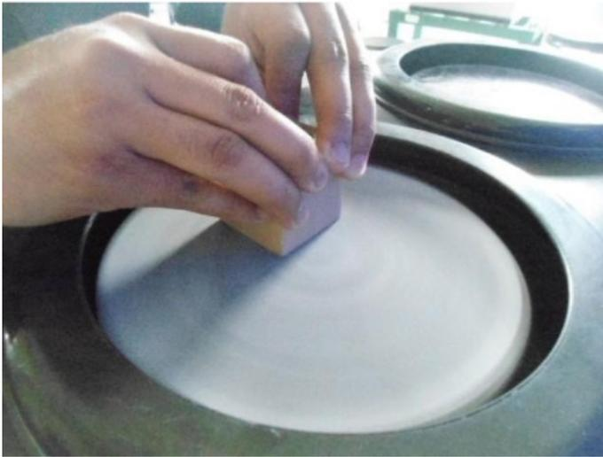
*Fig. 3. Fotografía del pulido de la cara de una probeta.*
