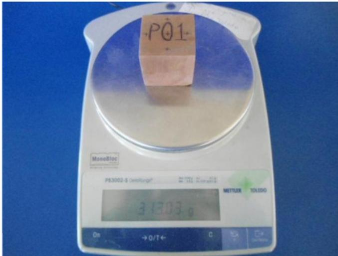
**Fig. 9. Fotografía del peso saturado probeta P01.**
