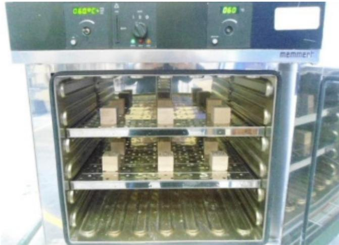
**Fig. 11. Fotografía del secado final de las probetas.**
