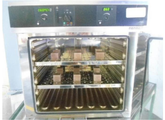
*Fig. 5. Fotografía del secado de las 12 probetas.*
