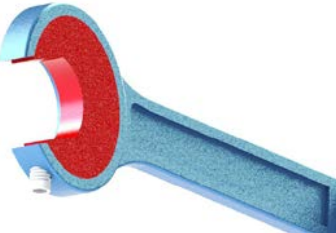
Figura 2. Opresor y boca acoplada a la herramienta base. Fuente: Elaboración propia.
