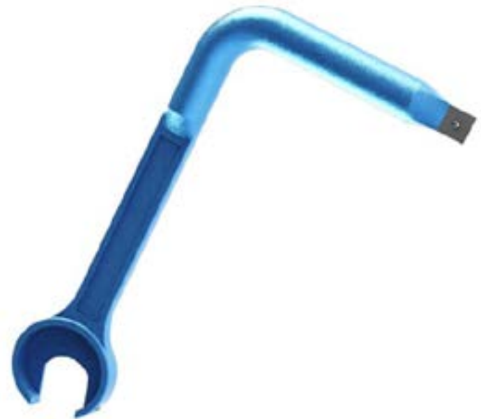
Figura 1. Diseño de la llave española con bocas intercambiables y maneral de fuerza acoplado. Fuente: Elaboración propia
