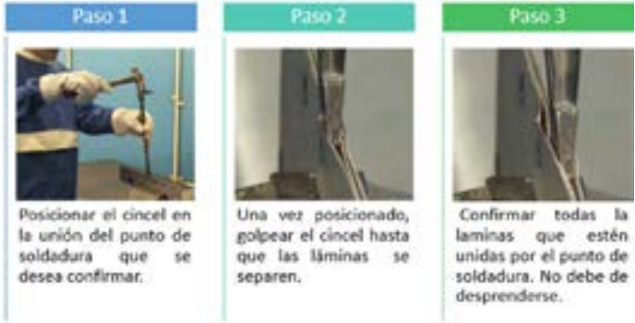
Figura 5. Proceso de confirmación de soldadura por cincel y martillo.
