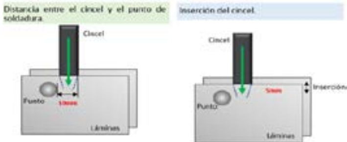
Figura 6. Puntos críticos de la confirmación de la calidad de la soldadura.
