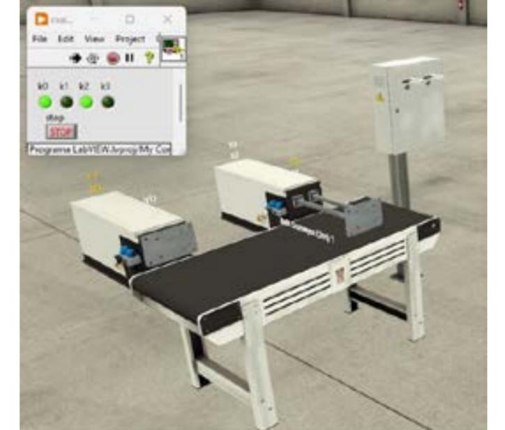
Fig. 26. Simulación de la secuencia de la Prensa perfiladora con el software LabVIEW y Factory I/O
